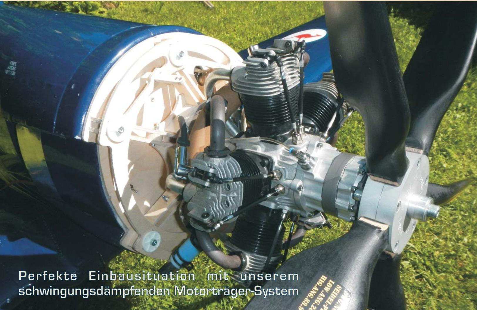
Perfekte Einbausituation mit unserem schwingungsdämpfenden Motorträger-System
