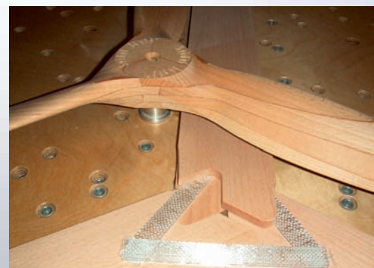
Um die Zugfestigkeit zu erhöhen, werden im Nabenbereich Glasbänder eingelegt. ▼
