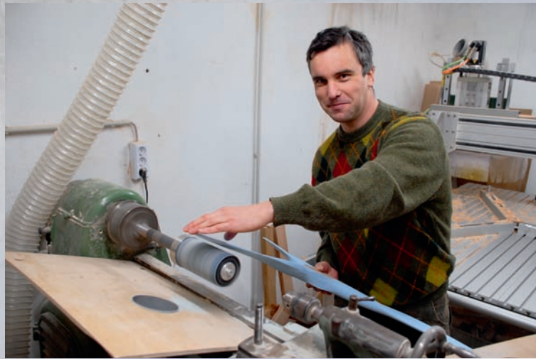
◀ Der Feinschliff erfolgt in Handarbeit. Eine Signalfarbe erleichtert den gleichmäßigen Abtrag.
